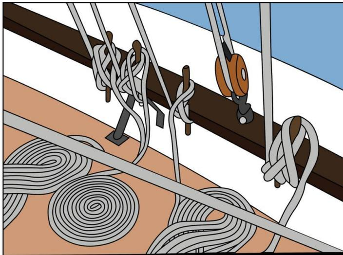
Der Begriff Tauwerk umfasst das gesamte System von Leinen, Schoten und anderen Seilen an Bord eines Schiffes, die zur Befestigung von Ausrüstung, zur Stabilisierung der Masten (Wanten und Stagen), zur Steuerung der Segel (Schoten) oder zum Anlegen am Hafen (Leinen) verwendet werden.
