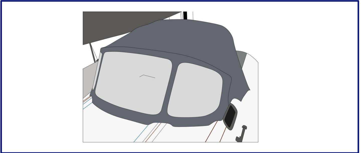
Die Sprayhood ist ein Halbverdeck aus Tuch für Yachten, das häufig einseitig acrylat- oder PU-beschichtet ist und mit einer leicht auf- und abbaubaren Konstruktion aus Edelstahl- oder Aluminiumrohren aufgespannt wird.
