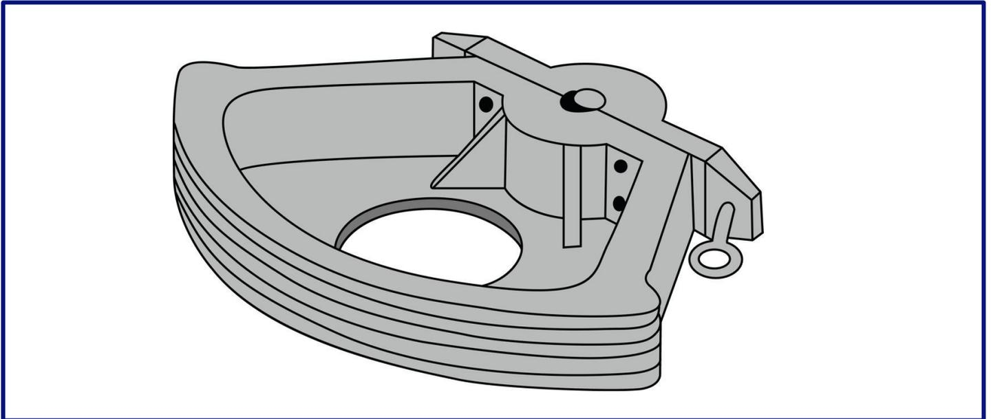
Ein Ruderquadrant ist eine mechanische Vorrichtung auf einem Schiff, die dazu dient, die Bewegungen des Ruders zu steuern. Es handelt sich um einen Viertelkreis, der mit dem Ruderblatt verbunden ist und mit einem Seil durch das Ruderrad gesteuert wird.
