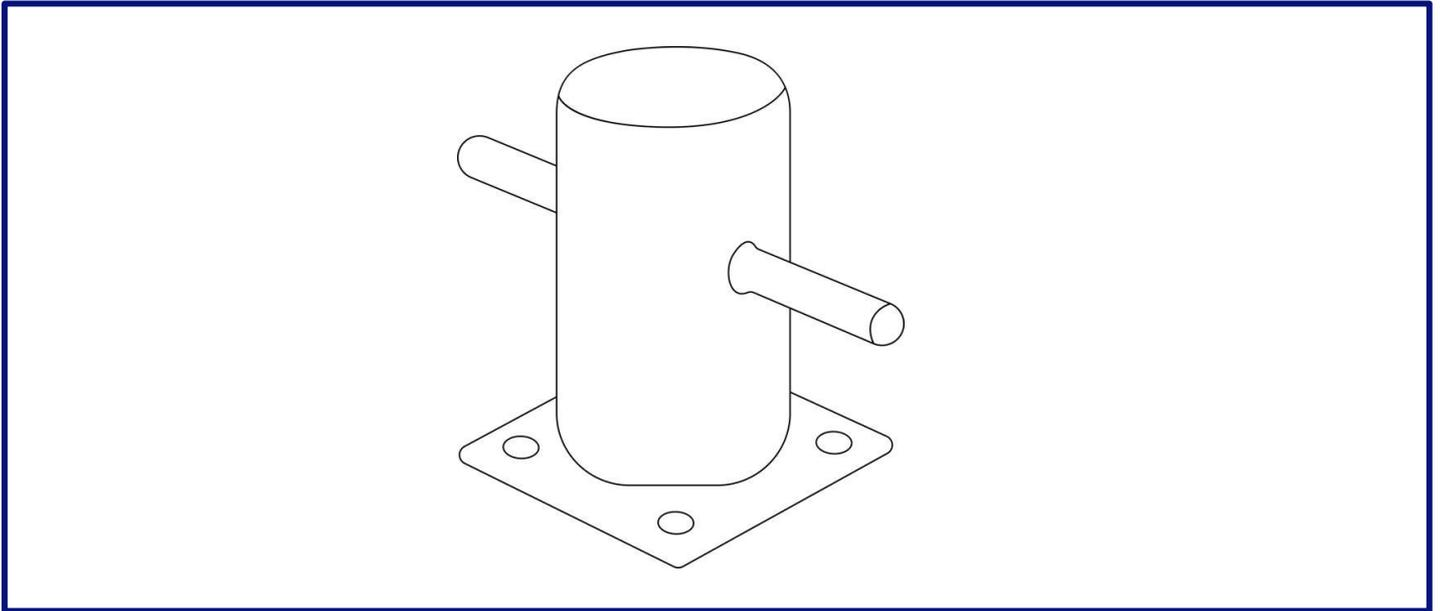
Poller sind kurze, dicke Pfähle, die sich auf einem Vordeck, einem Pier oder einer Brücke befinden und als Befestigungspunkte für das Schiff dienen. Die Festmacherleine wird straff um den Poller gewickelt und dann zurück zum Schiff geführt.
