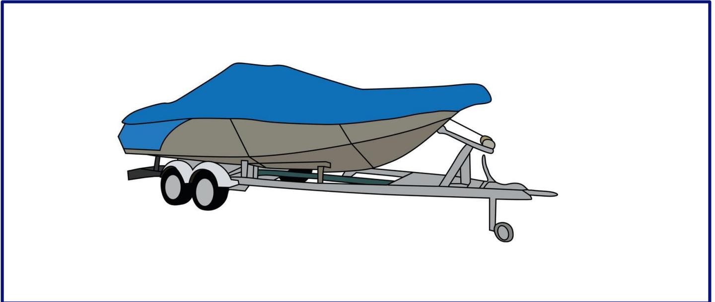
Das Persenning ist ein Schutzbezug, der als Abdeckung für Schiffe verwendet wird, um sie vor Witterung oder Spritzwasser zu schützen. Es handelt sich hierbei um ein imprägniertes, atmungsaktives Gewebe, wie zum Beispiel PVC.
