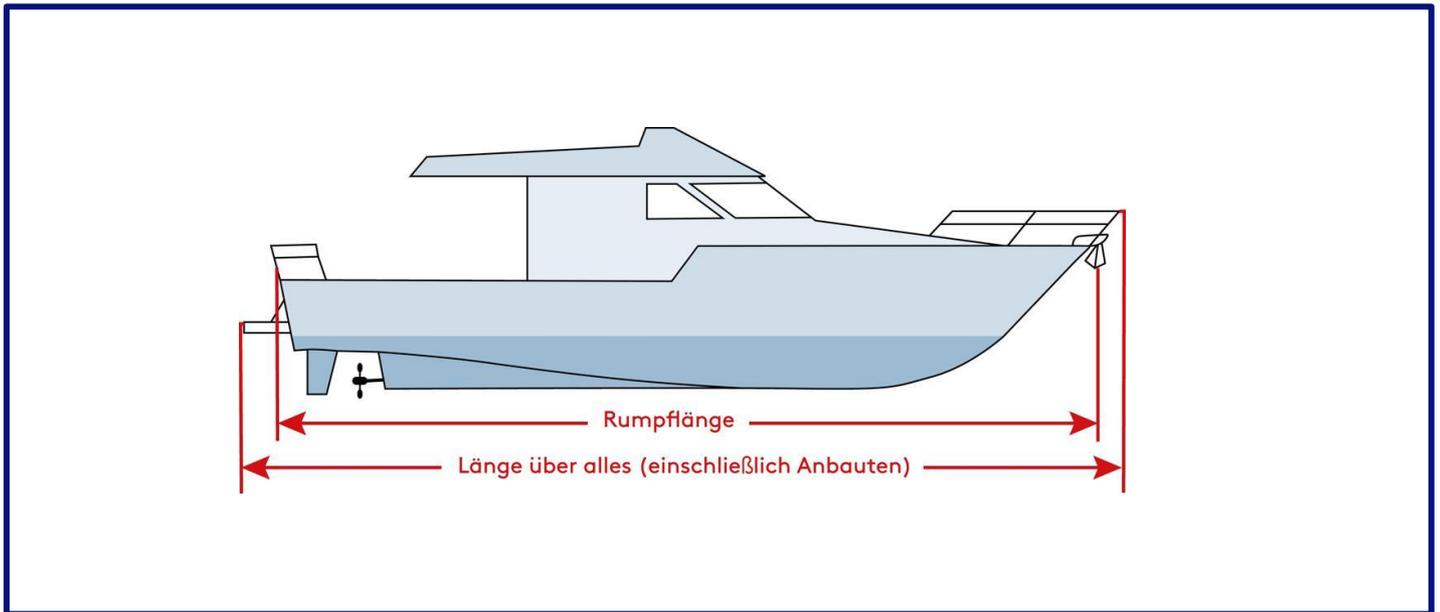
Die Länge über alles ist die Gesamtlänge eines Schiffes und ist nicht zu verwechseln mit der Rumpflänge. Beim Messen der Länge über alles werden die beiden tatsächlichen äußersten Punkte des Schiffes benutzt, also die Anbauten/Schiffsteile, die auch über den Rumpf hinausragen.
