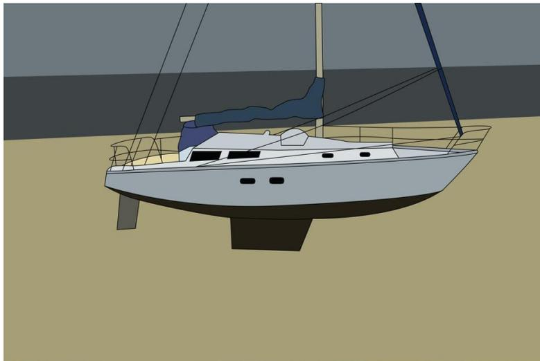
Der Grundbaustein eines Schiffes ist der Kiel, ein langezogener Balken oder eine Platte, die entlang der Schiffsunterseite verläuft und für Stabilität und Richtungsstabilität sorgt. Der Kiel ist im Grunde der tiefste Teil des Schiffes und dient dazu, das Schiff auf Kurs zu halten und ein Kentern zu verhindern.
