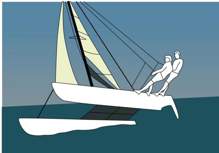
Katamaran ist die Bezeichnung für ein Schiff mit zwei parallelen Rümpfen, die durch einen Träger oder einen Rahmen miteinander verbunden sind. Der Katamaran hat weniger Widerstand im Wasser als ein Boot in traditioneller Bauweise, was eine höhere Geschwindigkeit und bessere Stabilität ermöglicht. Zudem ist das Risiko zu Kentern geringer
