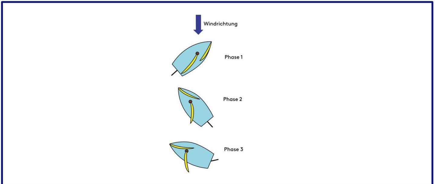
Beidrehen ist eine Manövertchnik in der Schifffahrt. Damit wird ein Schiff sicher gehalten oder seine Bewegungsrichtung geändert, ohne dass es vorwärts oder rückwärts fährt. Es ist eine wichtige Technik für Schiffe, die in engen oder gefährlichen Gewässern manövrieren müssen.
