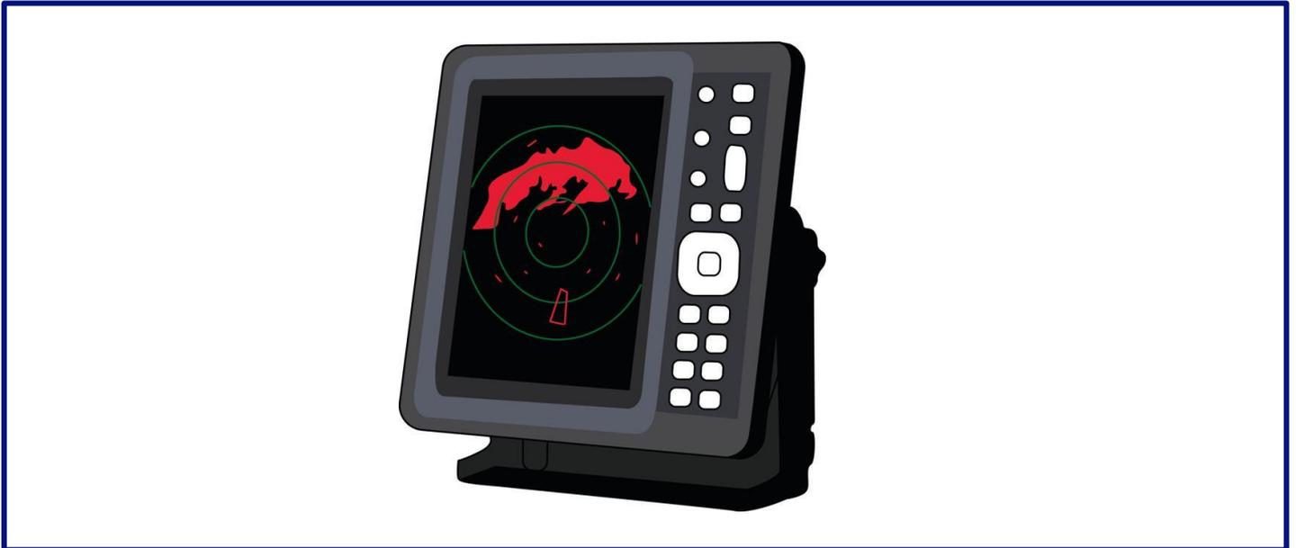
Ein elektronisches Gerät, das auf Schiffen zur automatischen Verarbeitung von Radardaten verwendet wird, ist in der Schifffahrtsindustrie als ARPA (Automatic Radar Plotting Aid) bekannt. Besonders bei schlechter Sicht oder dichtem Verkehr ist es eine entscheidende Navigationshilfe.
