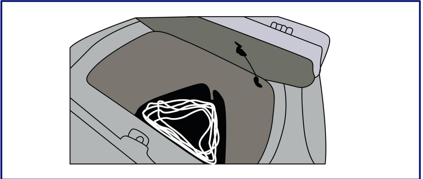
Der Anker und die zugehörigen Geräte werden in einem speziellen Fach in einem Schiff namens Ankerkasten aufbewahrt. Normalerweise befindet sich der Ankerkasten im Schiffsbogen und macht es einfach, den Anker fallen zu lassen und wieder einzuholen. Eine Öffnung im Schiffsbogen, die mit einer Klappe oder einem Deckel bedeckt wird, um die Anker- und Ausrüstung vor den Elementen zu schützen, macht einen typischen Ankerkasten aus.
