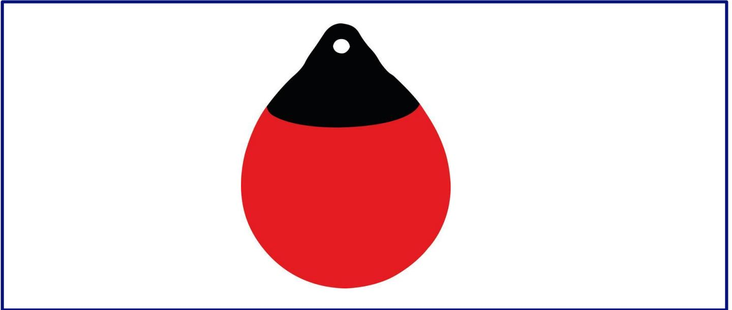
Um das Auffinden und Einholen des Ankers zu erleichtern ist eine Ankerboje eine Boje, die an der Stelle befestigt wird, an der sich der Anker auf dem Meeresboden befindet. Die Ankerboje wird typischerweise an der Kette des Ankers befestigt, so dass sie im Wasser schwimmen und als Markierung für die Position des Ankers dienen kann.
