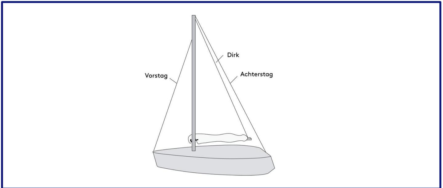
Als Achterstag wird ein stabiles Stahlseil bzw. Drahttau bezeichnet, welches zur Unterstützung des Mastes im hinteren Bereich (Achtern) des Schiffes dient. Es verläuft vom Masttopp aus (höchste Stelle eines Mastes) bis hin zum Heck eines Schiffes und verhindert somit, dass der Mast während starken Windes oder Wellenbewegungen nach vorne kippt oder instabil wird und sich zu viel biegt.
