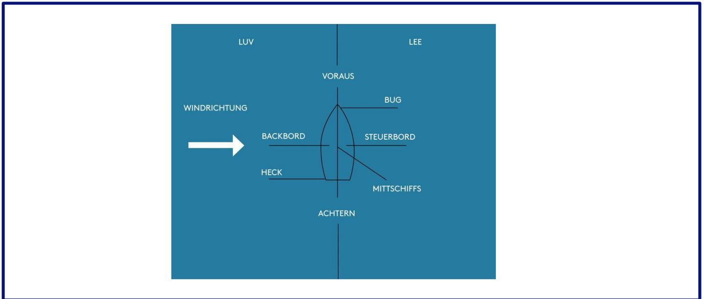
Achtern bezeichnet in der Schifffahrt die hinter Hälfte bzw. das hintere Ende eines Schiffes und wird als Ausdruck sehr häufig verwendet.
