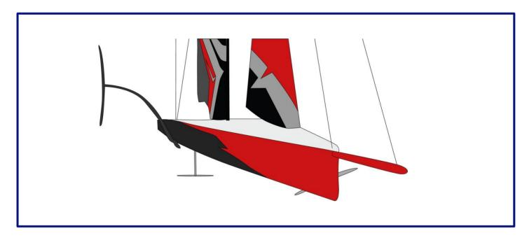
Die AC 75 ist eine der neusten Bootsklassen, welche 2021 im America's Cup segelte. Mit einer Rumpflänge von 20,70 Metern ca. 68 Fuß (Monohull Länge von 75 Fuß) und einem Gewicht zwischen 6,4 und 7,8 Tonnen muss das Segelboot von einer mindestens 11 Mann starken Crew gesegelt werden. Die jeweiligen Segelflächen der AC 75 betragen 145 Quadratmeter für das Großsegel, 90 Quadratmeter für das Genua und 200 Quadratmeter für das Gennaker.
