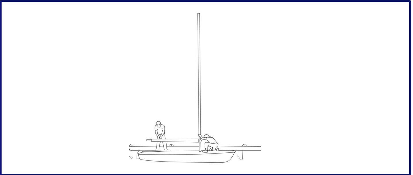
Das Abtakeln ist ein aufwendiger Prozess, bei dem Segel, Masten und Takelage des Schiffes entfernt werden. Im Gegensatz dazu steht das Auftakeln. Ein Schiff muss in der Regel abgetakelt werden, wenn es gewartet oder repariert wird oder aber transportiert bzw. gelagert werden muss. Das Abtakeln vereinfacht den Transport des Schiffes und sorgt dafür, dass Teile wie Mast nicht beschädigt werden können.
